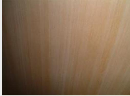
三、白蠟木：色澤白褐色，紋理細緻美觀，堅固耐用，硬度高不容易切割，加工性較差，不容易釘釘子，適合用在強度要求較高的運動用品，如球拍等。
