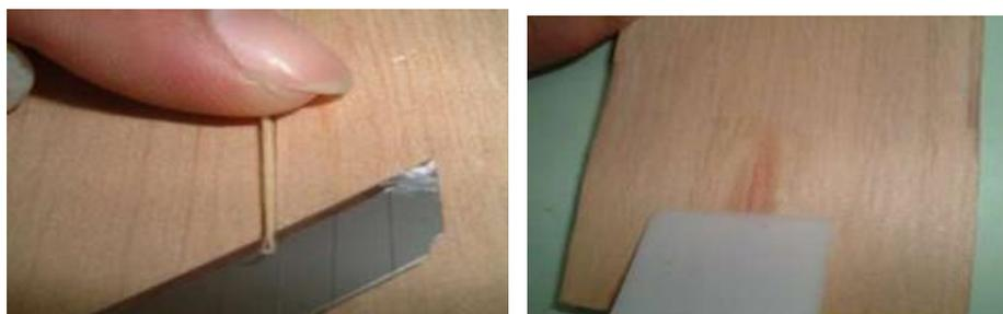
(三) 裂傷程度極輕微，無法用塞木條方法修補，可改用塞油灰，俟油灰乾燥一天後，再用細砂紙磨平表面即可。
